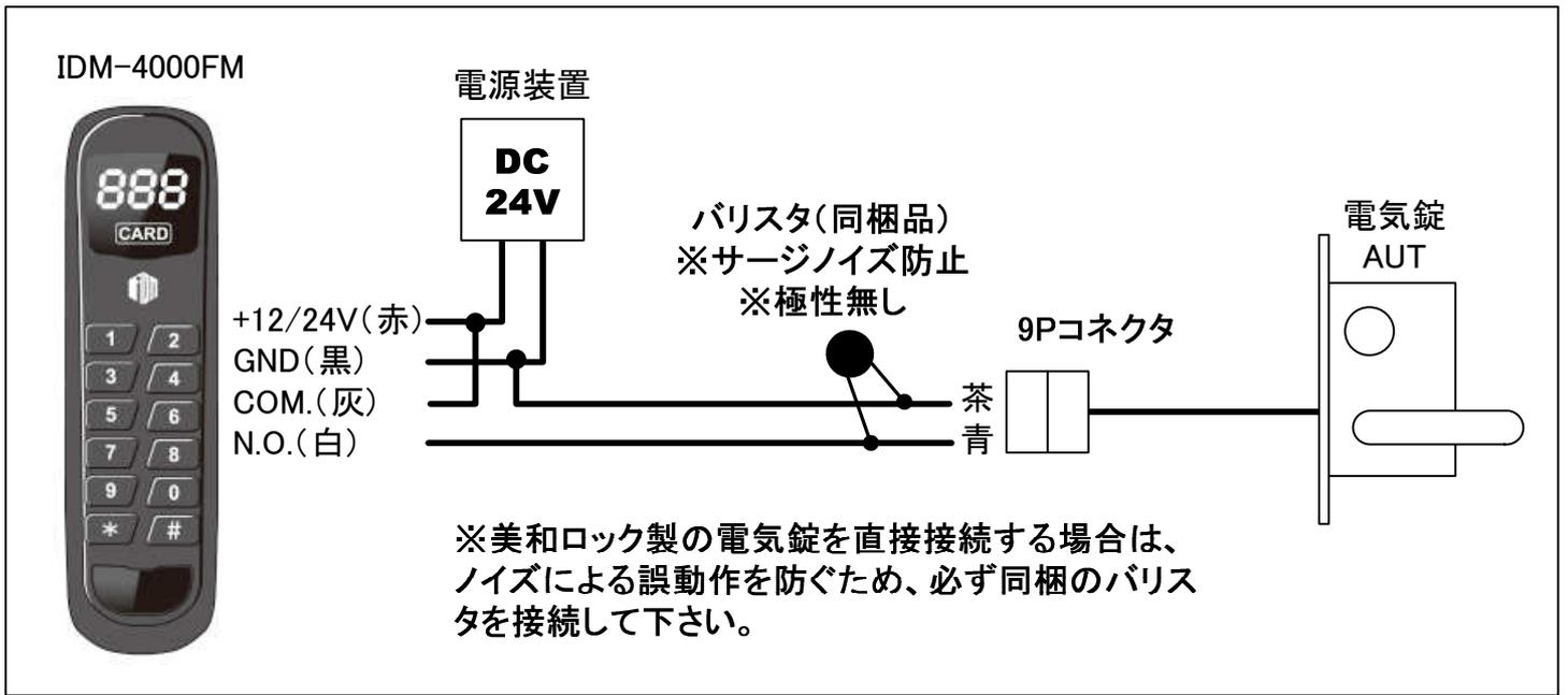
●美和ロック製 通電時施錠型電気錠 AURを使用する場合の接続
